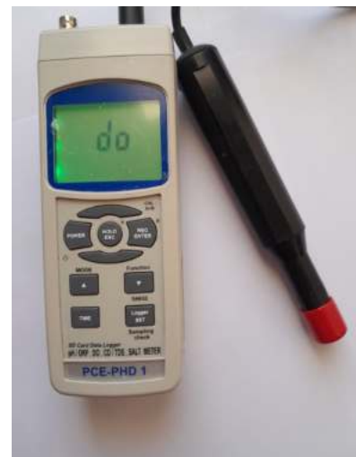
Figura 54: Fotografia de l'aparell utilitzat per mesurar la concentració d'oxigen i el seu sensor.
