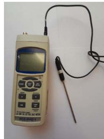
Figura 50: Fotografia de l'aparell utilitzat per mesurar la temperatura i el seu sensor.
