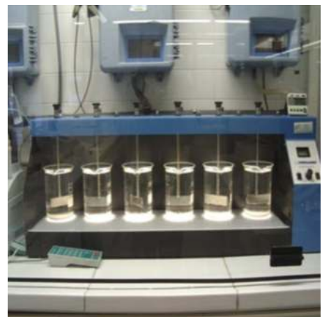
Figura 12: Jar Test per fer proves de coagulants i floculants.
