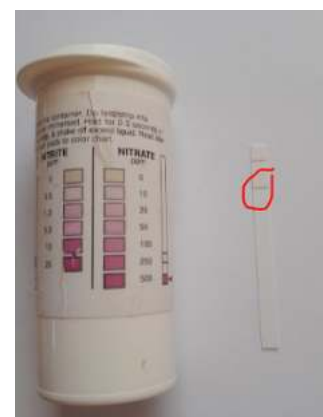
Figura 57: Imatge del pot amb tires reactives per mesurar nitrats.
