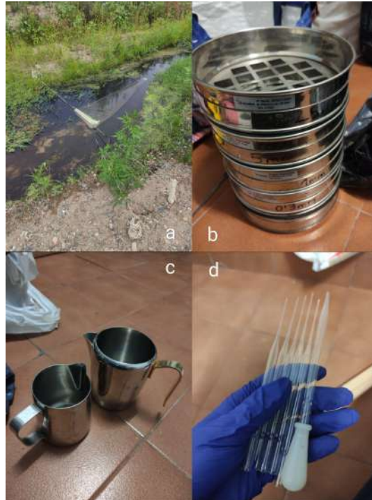
Figura 15. Materials del CEAB (a= xarxa manta; b= tamisos; c= lleteres inox; d= pipetes pasteur de vidre i xumet de silicona)
