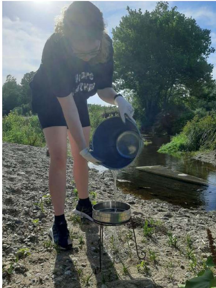
Figura 22. Imatge duent a terme la filtració activa amb la galleda inox i el tamís de 0,063 mm.
