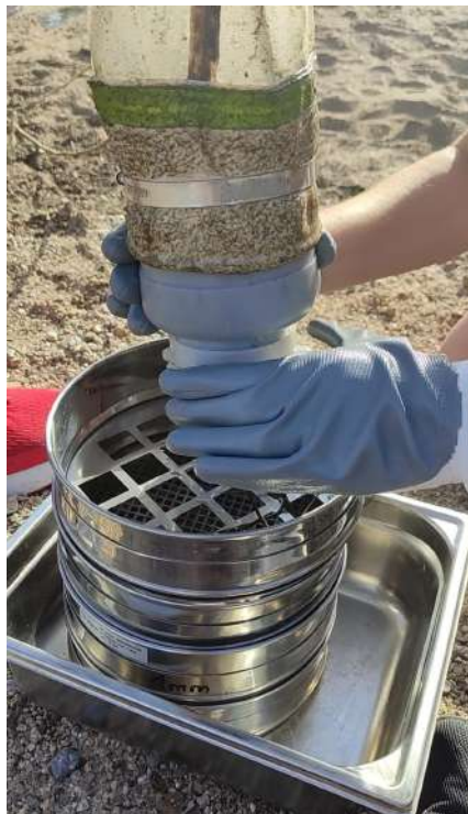
Figura 21. Moment en el qual es treu tot el que ha agafat la xarxa manta durant una hora, i, seguidament, s'agafen els residus del darrer tamís (de 0,3 mm).
