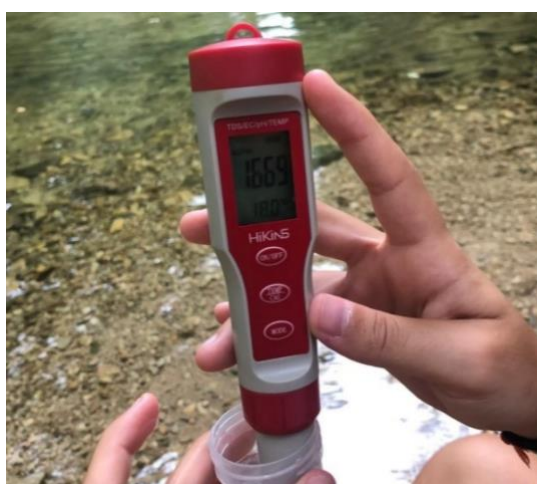
Figura 46. Mesurador digital de qualitat d'aigua (conductivitat, pH i temperatura). Fotografia dels autors
