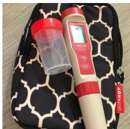
Figura 73: Mesurador digital de qualitat d'aigua (conductivitat, pH i temperatura)
