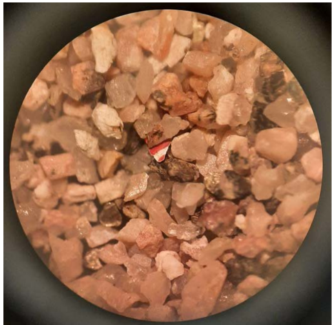
Figura 32 - Observació d'un microplàstic amb la lupa binocular. Font: pròpia
