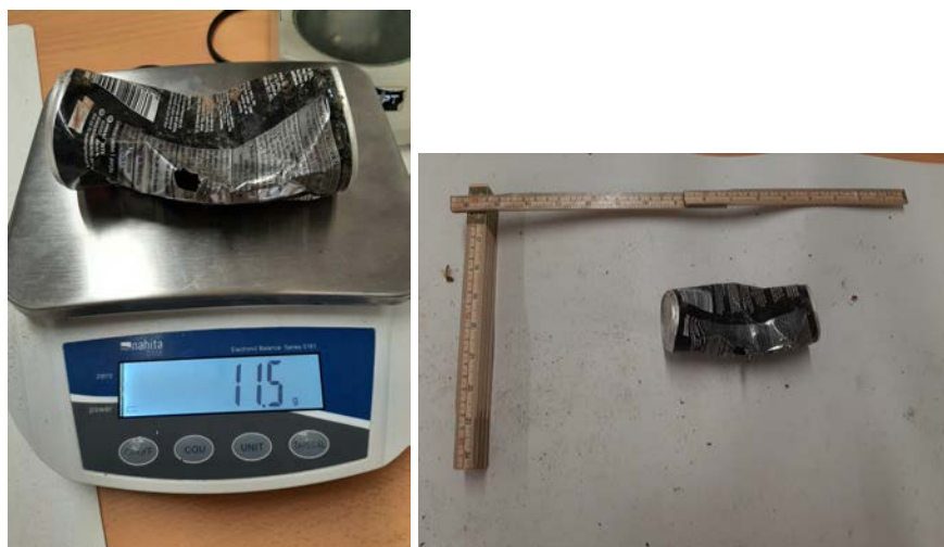
Figura 23 - presa de mesures dels macroplàstics al laboratori. Font: pròpia
