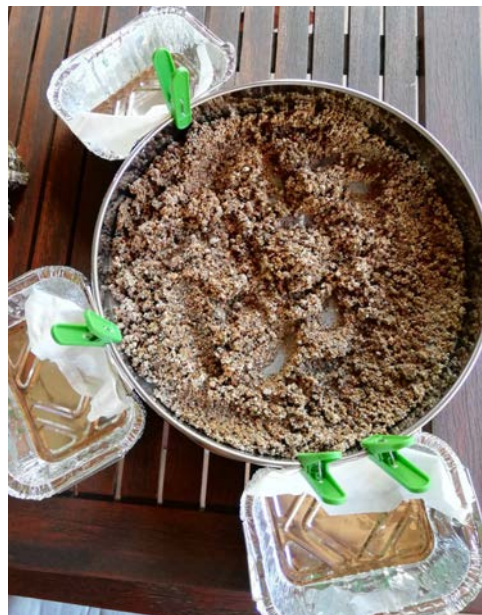
Figura 31 - procediment d'evaporació de l'aigua de les mostres de sediments. Font: pròpia
