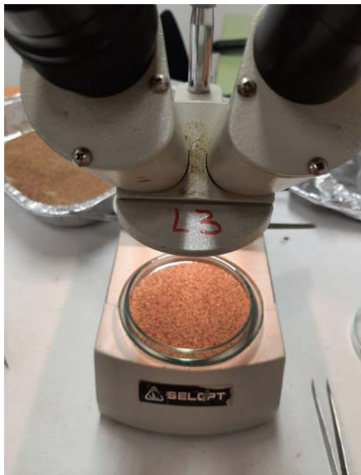
Figura 32 - Observació d'un microplàstic amb la lupa binocular. Font: pròpia
