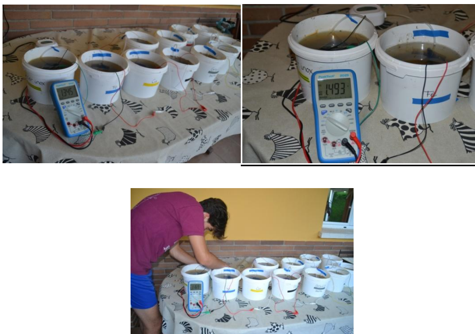
Imatge 34: Imatges de les cel·les connectades en sèrie. Font: Pròpia
