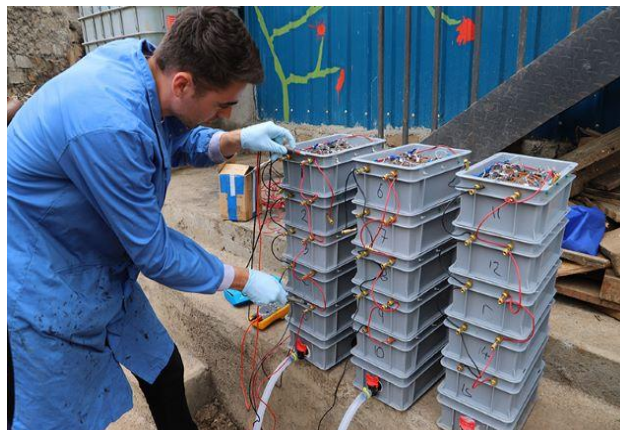
Imatge 21: Projecte de MFCs en stack Font: Robial.
